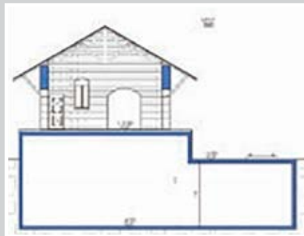
חלופה סכמטית של בנייה תת-קרקעית לבינוי החדש תחת בית המחסנים שישוחזר 'וכמן אדריכלים' ו'מעשה שימור'
