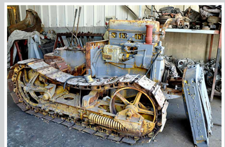
איור 4: במהלך השיפוצים. גם הצבע האפור של בלוק המנוע והרדיטור [המצנן] הכרסני אינו מקורי. הצבע הצהוב היה הצבע המקורי של הטוונטי-טו. ה'צהוב' הפך לצבע התקני וכמובן לסמל המסחרי של קטרפילר בשנת 1931.
