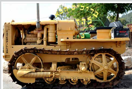
איור 5: הטוונטי-טו - שלב הסיום. התוספת המאוחרת - התנעה חשמלית. הסוללה מוקמה על הכנף השמאלית. במקור, על כנף זו היה מחובר ארגז כלים ידית ההתנעה, המנואלה ורצועת הרתימה שלה, שומרו.
