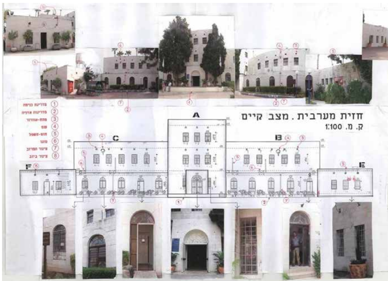
איור 11. תיעוד המצב הקיים של החזית המערבית. מפגעים פיזיים: מזגנים, כבלים, פתחים, צמחייה, מרזבים. מקור: תיק תכנון ושיקום של האתר, יוני 2009
